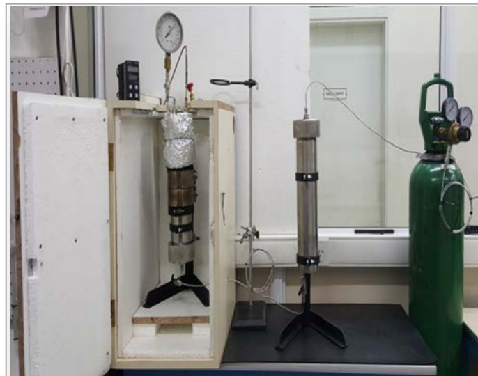
Fig. 13 – Celda construida para analizar, a presión y temperatura, la imbibición de muestras de baja permeabilidad.
